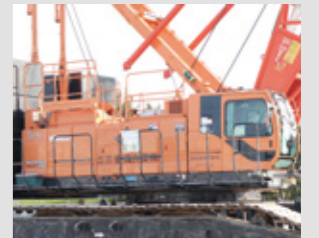
GTL燃料を使用した200tクローラークレーン
