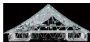
(上) 既存の点群データ (下) 既存の点群データをもとに、新設のトラス鉄骨を計画
