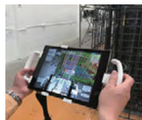
開発中の端末上でBIMと実像を高精度に重畳表示するシステム
