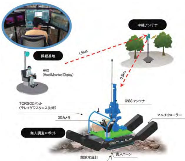
(上)中継アンテナを設置することにより、操縦基地から約2km先の遠隔操作が可能
