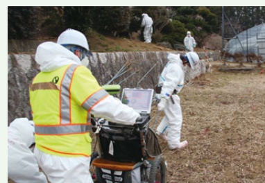
GPSを搭載したバギー式の放射線計測システムで汚染状況を把握
