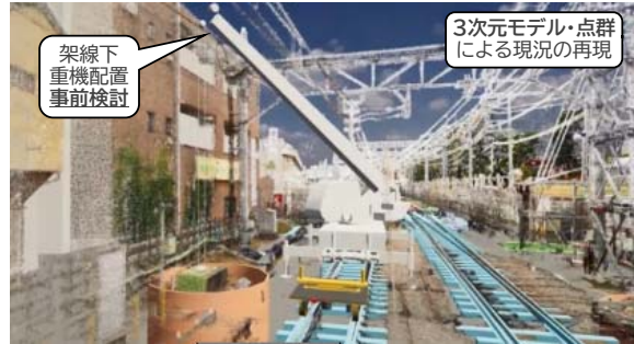
鉄道工事における重機配置の検討
