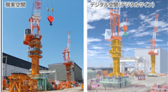
ORCISM®(2)によるデジタルツインを活用したクレーンの遠隔・自動運転
