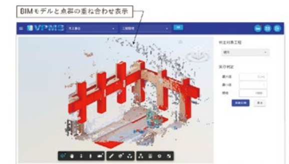
BIMモデルと点群データの重ね合わせによる実存判定
