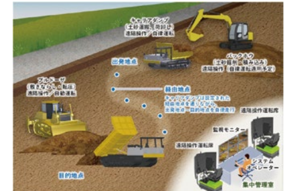
建設機械の遠隔操作、自動・自律運転による施工概要
