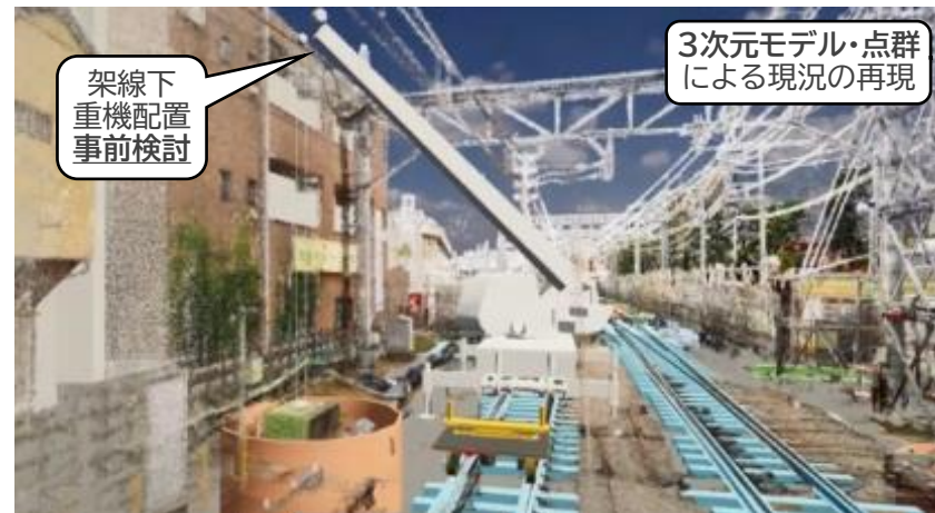
鉄道工事における重機配置の検討
