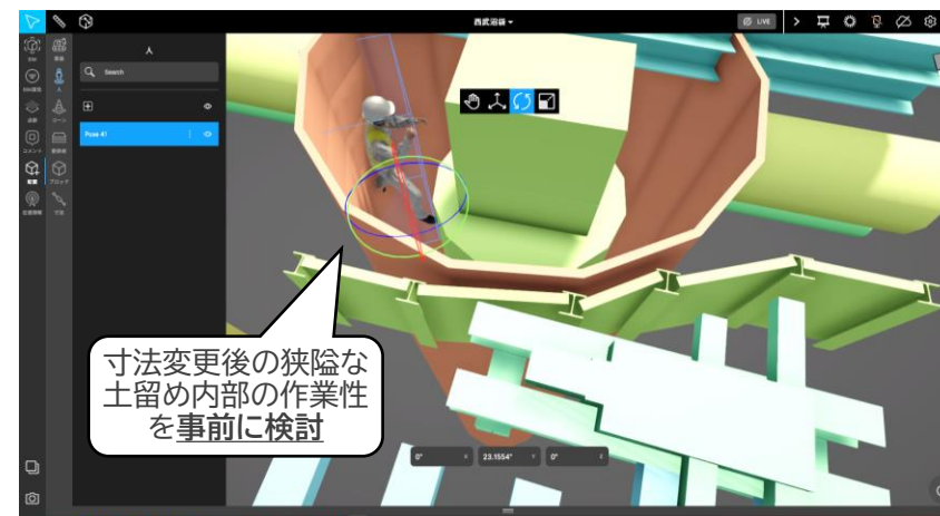
土留内部作業の事前検討
